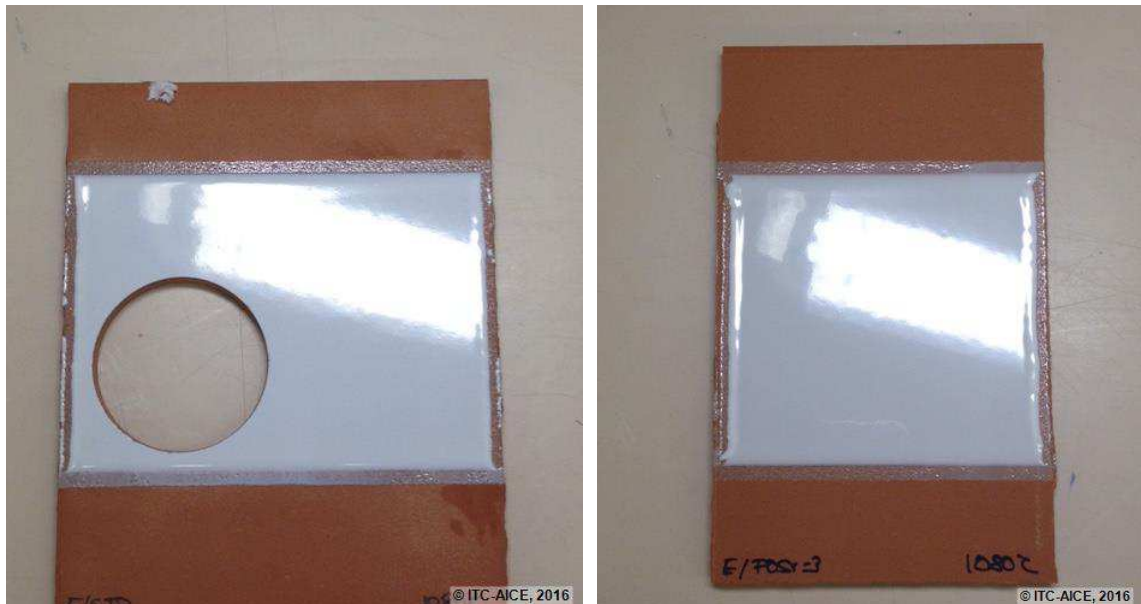
Figura 28 Fotografías de las piezas obtenidas con la frita FO (izquierda) y la frita FOSr-3 (derecha) a la temperatura de 1080°C.
