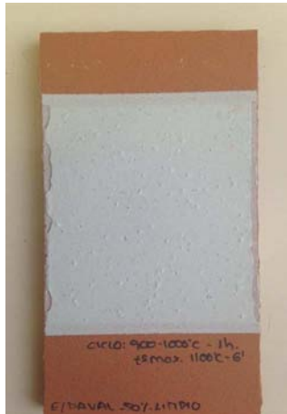
Figura 32 Pieza obtenida a partir del residuo limpio de material magnético (Fe). Cocción lenta.
