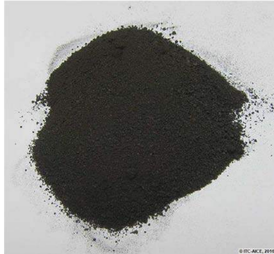
Figura 9. Aspecto de la muestra tras una segunda calcinación a 1000°C
